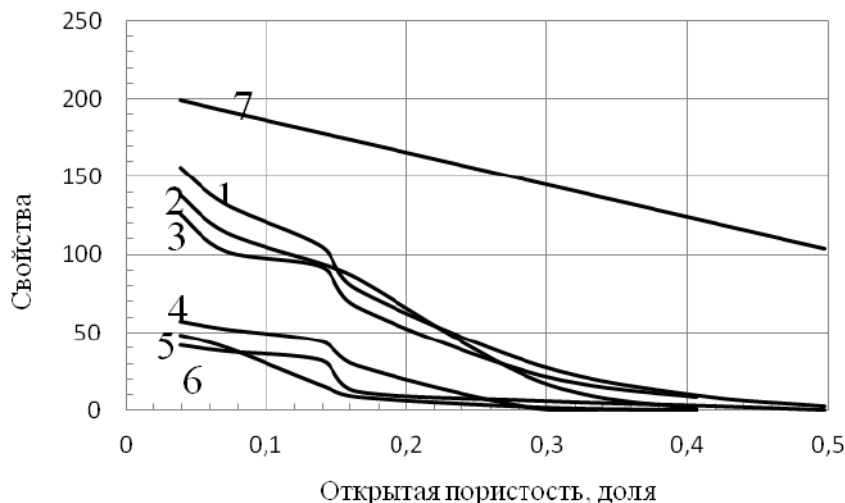
Рисунок 4 - Формирование уровня физико-механических свойств четырёхмерно армированного УУКМ в процессе формирования углеродной матрицы методом изостатической карбонизации. 1 – прочность при сжатии, МПа; 2 – прочность при растяжении, МПа; 3 – прочность при изгибе, МПа; 4 – модуль упругости при растяжении, ГПа; 5 – модуль упругости при изгибе, ГПа; 6 – модуль упругости при сжатии, ГПа; 7 – кажущаяся плотность, [100×γ]г/см 3 .
