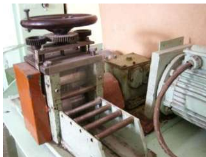
Рисунок 1 - Общий вид установки для исследований дефекта «вкатанная окалина»
