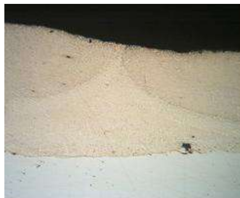
Рисунок 2- Поперечное сечение мультимодального полосчатого покрытия x50
