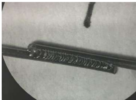
Рисунок 1 – Вид соединения нитиноловой проволоки внахлест лазерной сваркой
