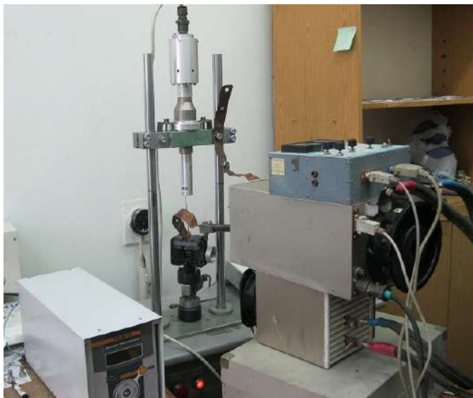
Рисунок 1 - Экспериментальная установка для совместного воздействия на проволоку импульсного тока и ультразвуковых колебаний при растяжении
