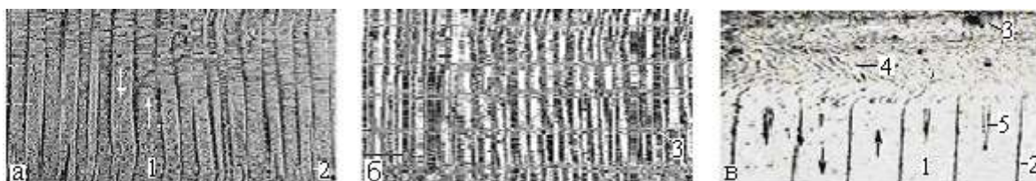
Рисунок 1- Магнитная доменная структура ЭТС до (а), после (б) ЛЛО и в зоне (в) ЛО. 1–180° полосовые домены; 2–граница между доменами; 3–зона ЛО и измельченные домены;
