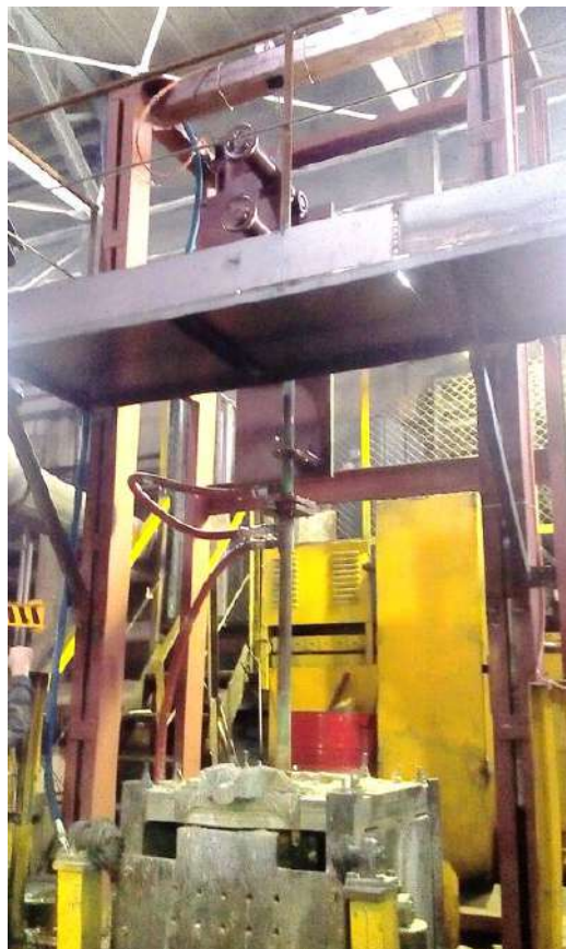
Рисунок 2 - Установка непрерывного литья вверх на КУЗОЦМ
