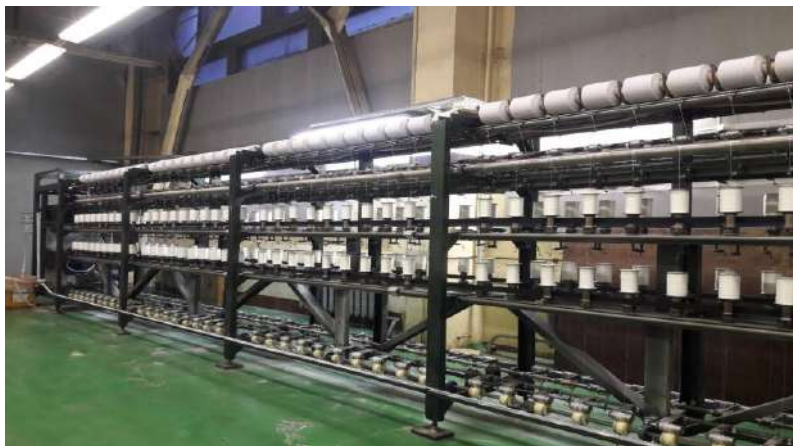
Рисунок 1 – Общий вид машины для производства латексных оплетенных нитей
