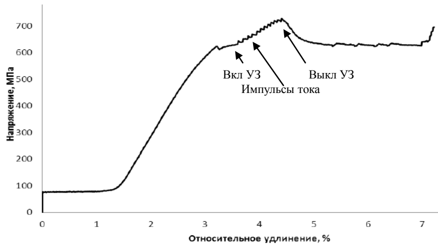
Рисунок 4 - Кривая «напряжение-деформация» при растяжении сплава Ti-50,0ат.%Ni с одновременным введением ультразвука и импульсов тока при 20°С
