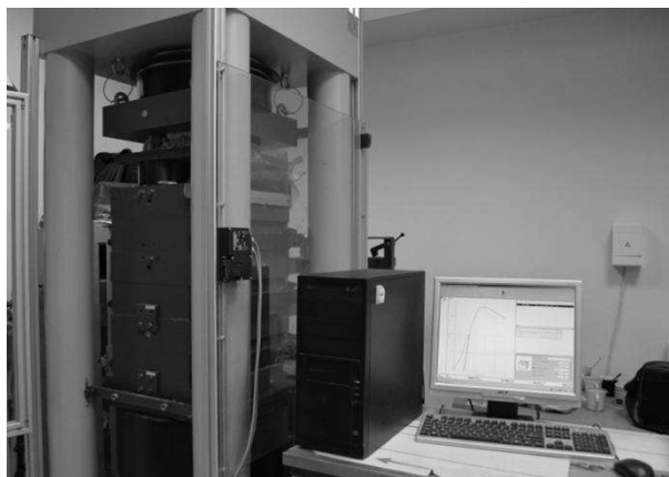
Рисунок 1- Проведения испытаний на образцах различной геометрической конфигурации на прессе ToniNorm2041
