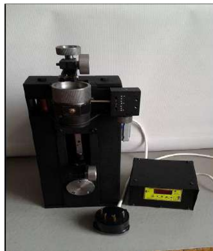
Рисунок 2 - Станок для полировки волок обычного исполнения
